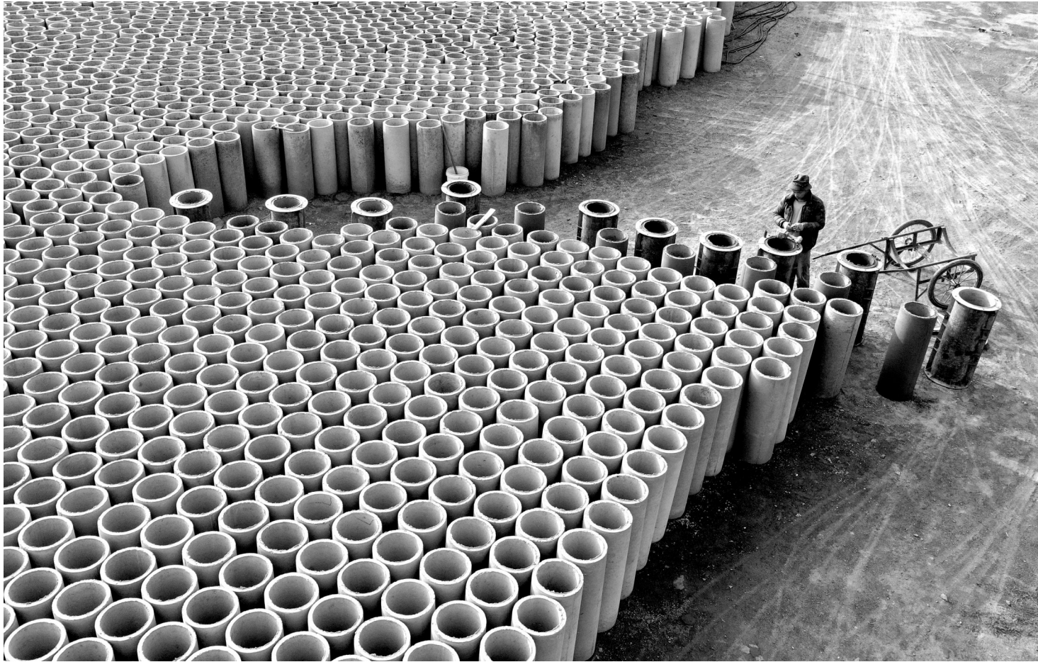
近年来,江西省吉安市永丰县着力推进高标准农田建设,集中建设一批打基础、管长远、惠民生的农田水利工程,推动农业产业结构调整和优化升级,助力脱贫攻坚。图为近日,工人正在制作用于高标准农田水利冬修的过水涵管。
