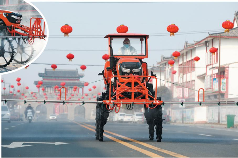
新冠肺炎疫情发生以来,江苏省连云港市赣榆区塔山镇利用高地隙喷杆喷雾机勾兑药水在镇区及周边村庄实施防控消毒作业。高地隙喷杆喷雾机采用机械化作业、省工省力,而且雾化效果好、喷幅宽、喷洒面积大。图为2月9日,农机手驾驶高地隙喷杆喷雾机实施消毒作业。 司伟 李隔 摄
